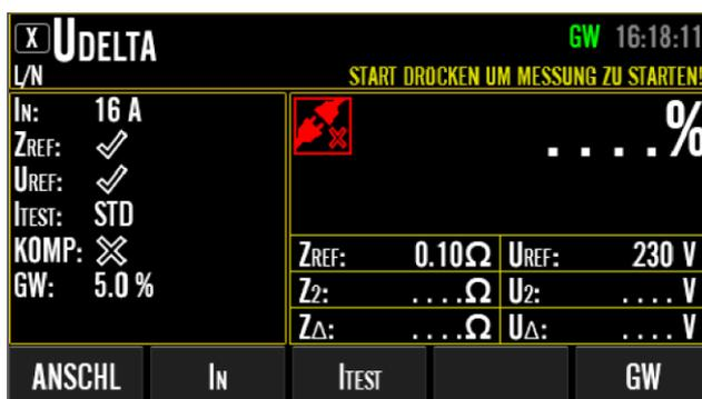
Abbildung 35: UDELTA-Ruhebildschirm mit erweiterter Auswahl an Menütasten (nach dem Drücken der Menütaste "BEARBEITEN"), Beispiel
