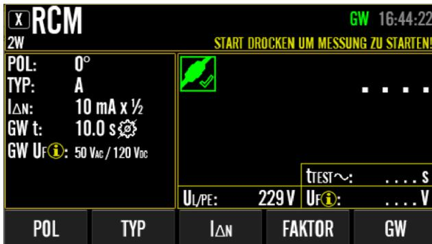
Abbildung 51: Ruhebildschirm in RCM-Messung mit erweitertem Menütastenspektrum (nach Drücken der Menütaste "BEARBEITEN"), Beispiel
