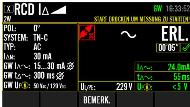
Abbildung 47: RCD I $\Delta$  Beispiel Messergebnis
