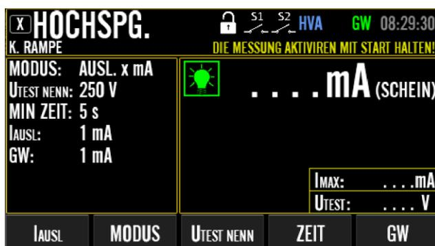
Abbildung 71: HS-Ruhebildschirm (KEINE RAMPE-Messung, AUSL.-x mA-Modus) mit erweitertem Menütastenspektrum (nach Drücken der Menütaste "BEARBEITEN"), Beispiel
