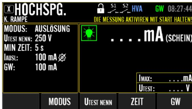
Abbildung 70: HS-MESSUNG (KEINE RAMPE-Messung, AUSLÖSUNG-Modus) Ruhebildschirm mit erweitertem Menütastenbereich (nach Drücken der Menütaste "BEARBEITEN"), Beispiel
