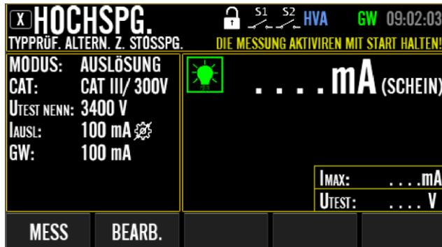
Abbildung 80: HS-Ruhebildschirm (TYPPRÜFUNG ALTERN. Z. STOSSPG.) mit erweitertem Menütastenbereich (nach Drücken der Menütaste "BEARBEITEN"), Beispiel
