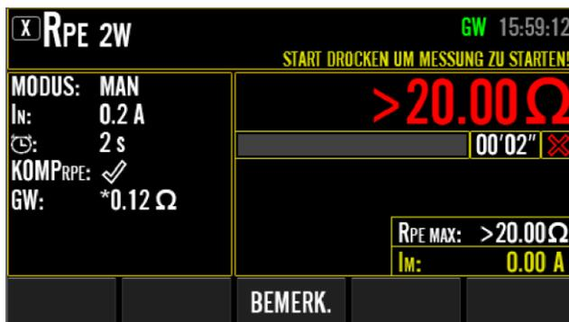
Abbildung 18: Endergebnis in RPE 2L Messung, Beispiel
