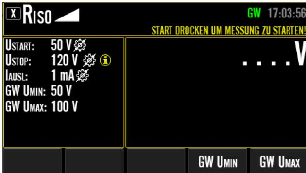
Abbildung 65: RISO  $\blacktriangleleft$  -Ruhebildschirm mit erweitertem Menütastenspektrum (nach Drücken der Menütaste "BEARBEITEN"), Beispiel
