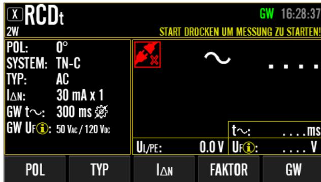
Abbildung 43: Ruhebildschirm in RCDt-Messung mit erweitertem Tastenspektrum (nach Drücken der Menütaste "BEARBEITEN"), Beispiel
