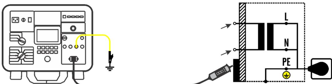
Abbildung 107: Verbindung zur Berührungsstrommessung, Beispiel.
