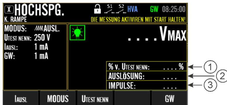
Abbildung 69: HS (KEINE RAMPE-Messung, ⚡ AUSLÖSUNG-Modus) Ruhebildschirm mit erweitertem Menütastenumfang (nach Drücken der Menütaste "BEARBEITEN"), Beispiel
