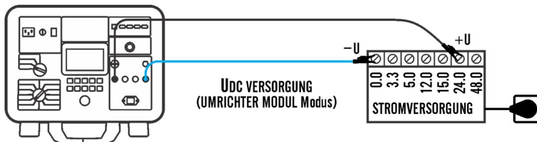
Bild 136: Anschluss für UDC-VERS.-Messung (ANTRIEBSMODUL-Modus), Beispiel.
