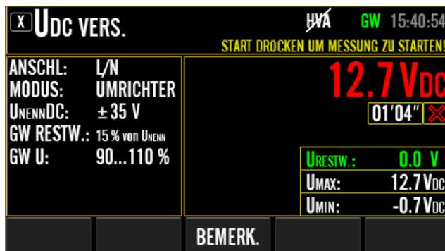
Abbildung 137: Endergebnis in der UDC VERS.-Messung, Beispiel
