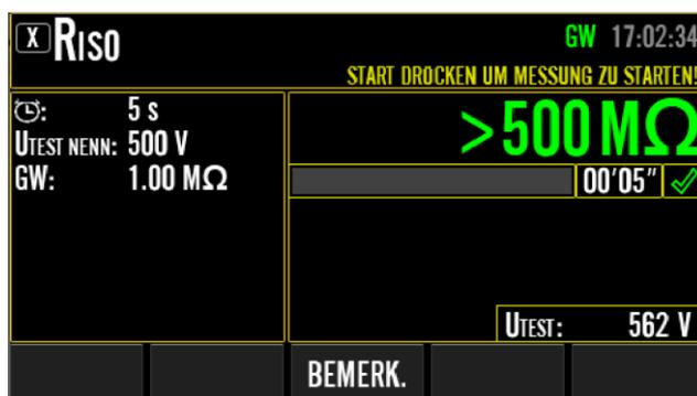
Abbildung 64: Ergebnis der RISO-Messung, Beispiel
