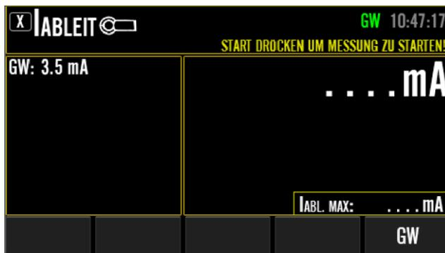
Abbildung 103: I<sub>ABLEIT</sub> Ruhebildschirm mit erweiterter Auswahl an Menütasten, Beispiel (nach dem Drücken von Menütaste "BEARBEITEN")
