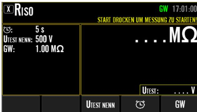
Abbildung 61: RISO-Ruhebildschirm mit erweitertem Menütastenspektrum (nach Drücken der Menütaste "BEARBEITEN"), Beispiel
