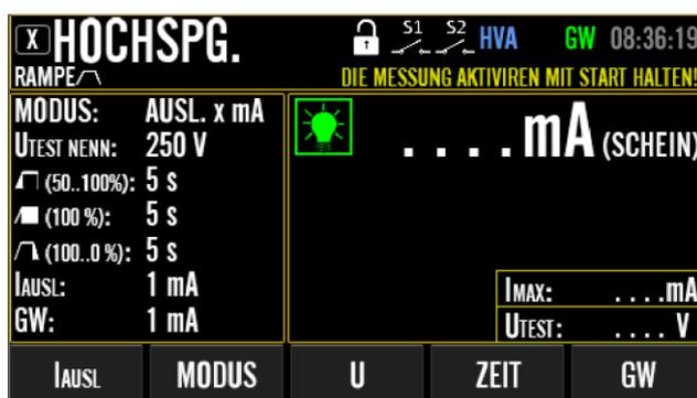
Abbildung 75: HS-Ruhebildschirm (RAMPE
