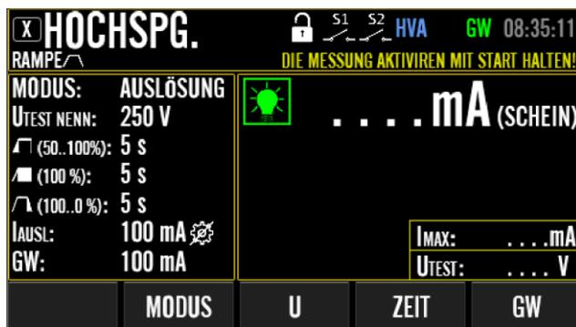
Abbildung 74: HS (RAMPE
