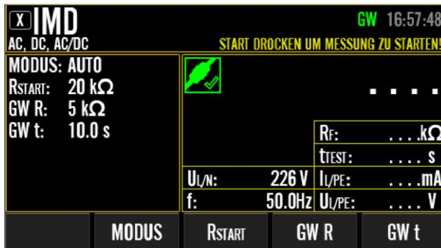
Abbildung 59: Ruhebildschirm in IMD-Messung (AUTO-Modus) mit erweitertem Menütastenspektrum (nach Drücken der Menütaste "BEARBEITEN"), Beispiel
