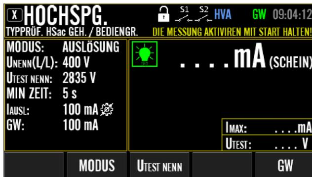
Abbildung 81: HS (TYPPRÜFUNG HSAC GEH./BEDIENGR.-Messung, AUSLÖSUNG-Modus)
