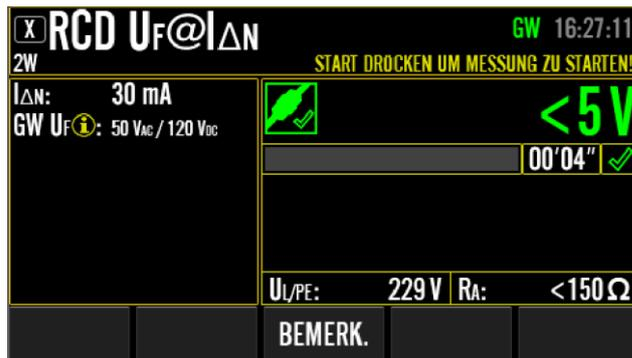
Abbildung 42: RCD  $U_F@I_{\Delta N}$  Messergebnis-Beispiel
