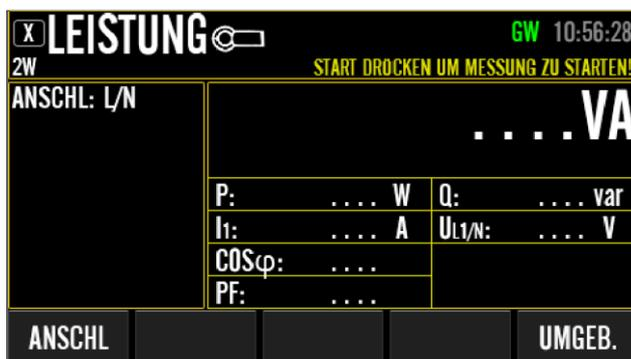
Abbildung 114: LEISTUNG-Ruhebildschirm mit erweitertem Menütastenbereich, Beispiel (nach dem Drücken von Menütaste "BEARBEITEN")
