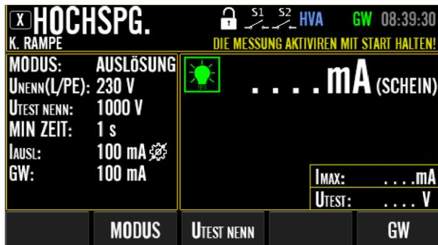
Abbildung 77: HS-Ruhebildschirm (AUSLÖSUNG-Modus) mit erweitertem Menütastenspektrum (nach Drücken der Menütaste "BEARBEITEN"), Beispiel
