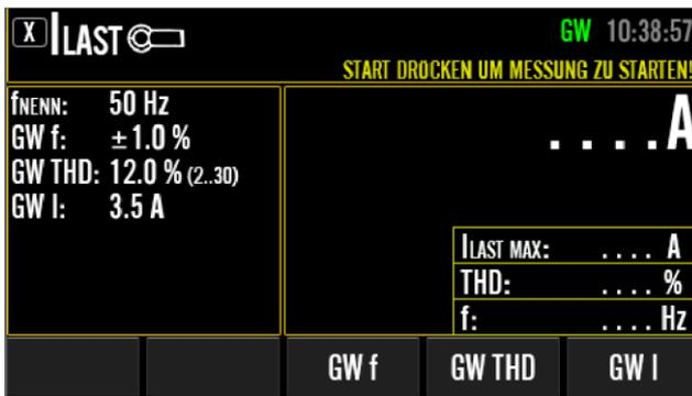
Abbildung 100: ILAST Ruhebildschirm mit erweitertem Menütastenbereich, Beispiel (nach dem Drücken der Menütaste "BEARBEITEN")
