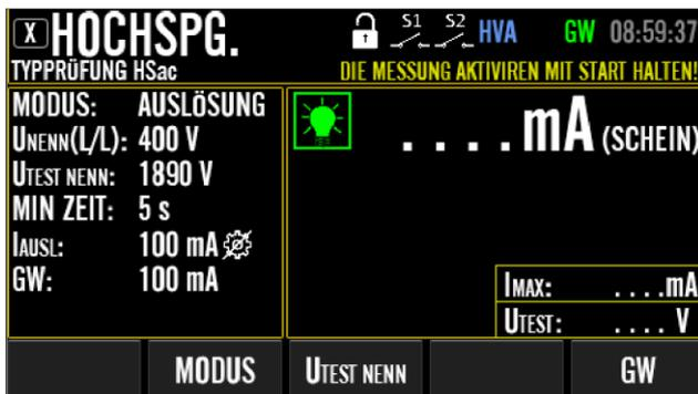
Abbildung 79: HS (TYPPRÜFUNG HSAC, AUSLÖSUNG Modus) Ruhebildschirm mit erweitertem Menütastenbereich (nach Drücken der Menütaste "BEARBEITEN"), Beispiel
