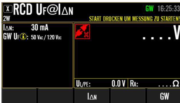
Abbildung 40: Ruhebildschirm in RCD UF@I $\Delta$ N-Messung mit erweitertem Menütastenbereich (nach Drücken der Menütaste "BEARBEITEN"), Beispiel
