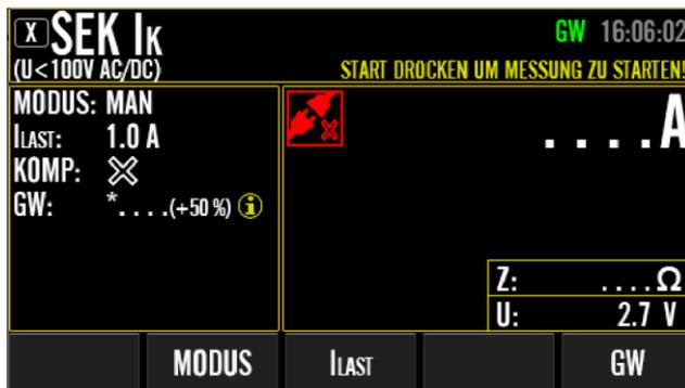
Abbildung 27: SEK Ik ( $U < 100V$  AC/DC) Ruhebildschirm mit erweitertem Bereich der Menütasten (nach Drücken der Menütaste "BEARBEITEN"), Beispiel
