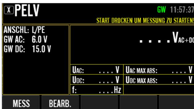
Abbildung 124: PELV Ruhebildschirm mit erweitertem Menütastenbereich, Beispiel (nach dem Drücken von Menütaste "BEARBEITEN")
