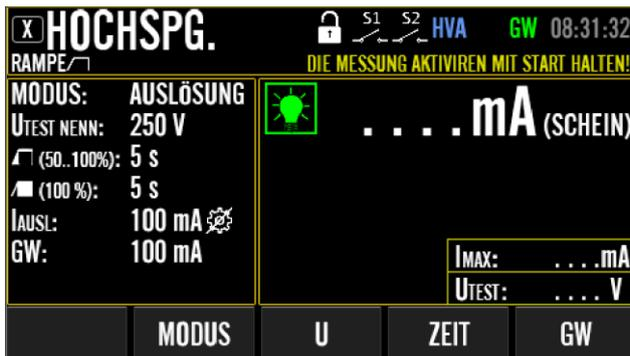
Abbildung 72: HS (RAMPE
