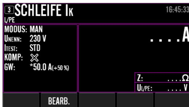
Abbildung 148. Gewählter Prüfschritt (SCHLEIFE) auf der dritten Ansichts-/Bearbeitungsebene, d.h. dem Messbildschirm, Beispiel
