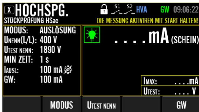
Abbildung 82: ROUTINEMÄSSIGE PRÜFUNG-HSAC-Messung, AUSLÖSUNG-Modus) Ruhebildschirm mit erweitertem Menütastenbereich (nach Drücken der Menütaste "BEARBEITEN"), Beispiel
