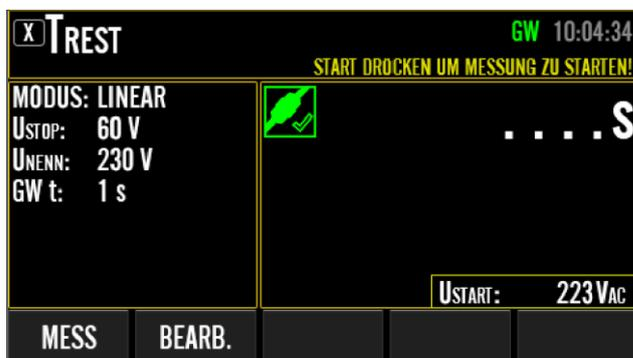
Abbildung 95: Leerlaufschirm in TREST-Messung, Beispiel
