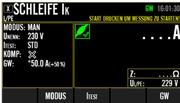
Abbildung 19: SCHLEIFE Ik (L/PE) Ruhebildschirm mit erweiterter Auswahl an Menütasten (nach Drücken der Menütaste "BEARBEITEN"), Beispiel
