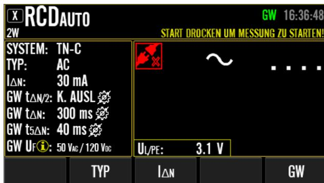
Abbildung 49: Ruhebildschirm in RCDAUTO-Messung mit erweitertem Tastenspektrum (nach Drücken der Menütaste "BEARBEITEN"), Beispiel
