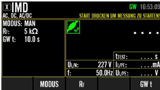
Abbildung 56: Ruhebildschirm in IMD-Messung (MAN-Modus) mit erweitertem Menüastenspektrum (nach Drücken der Menüaste "BEARBEITEN"), Beispiel
