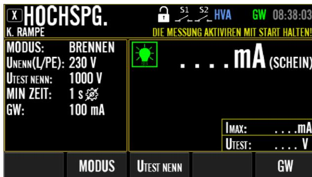
Abbildung 76: HS-Ruhebildschirm (BRENNEN-Modus) mit erweitertem Menütastenbereich (nach Drücken der Menütaste "BEARBEITEN"), Beispiel
