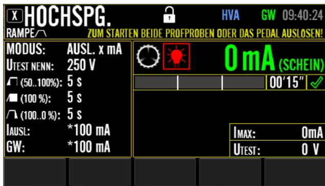
Abbildung 85: Endergebnis im HS- Prüfung, Beispiel
