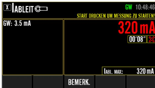
Abbildung 105: Endergebnis der IABLEIT-Messung, Beispiel
