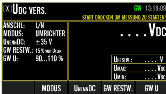
Abbildung 133: UDC-VERS Ruhebildschirm mit erweitertem Menütastenspektrum, Beispiel (nach Drücken der Menütaste "BEARBEITEN")
