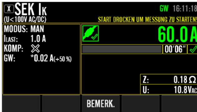
Abbildung 30: Endergebnis der SEK Ik ( $U < 100V$  AC/DC) Messung , Beispiel
